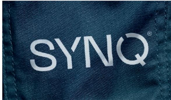
Dieses einfache und kosteneffiziente Druckverfahren eignet sich besonders für detaillierte, buntfarbige Designs. Bei Thermotransferdruck sind die Anwendungsdauer, die Temperatur und der Druck wichtige Faktoren, die zu berücksichtigen sind. Erkundigen Sie sich bei Ihrem Druckpartner, welche Einstellungen für die von Ihnen gewählte Thermotransfer und Stoff gelten.
