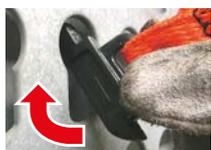
Den Adapter mit der oberen Seite zuerst in die Befestigungsöffnung des Schlüsselochprofils einführen.
