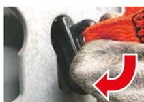
Den Adapter mit der unteren Seite in die Befestigungsöffnung des Schlüsselochprofils einführen.
