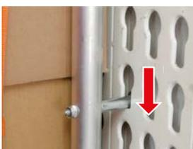
Die Haltestange mit den Adaptern in das Schlüssellochprofil einstecken und im Schlüssellochprofil nach unten führen.
