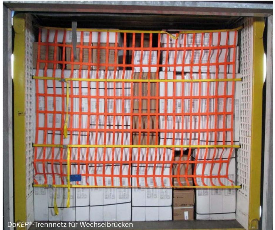
DoKEP®-Trennnetz für Wechselbrücken
