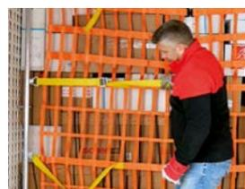
Das Trennnetz verspannen, indem die 4 Schnellspanner mit Hilfe der Handschlaufen angezogen werden.
