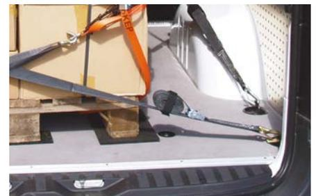
Das gewählte Netz verfügt über ausreichend Befestigungspunkte und Schnellspanner, die genau auf die Zurrpunkte im Fahrzeug abgestimmt sind.
