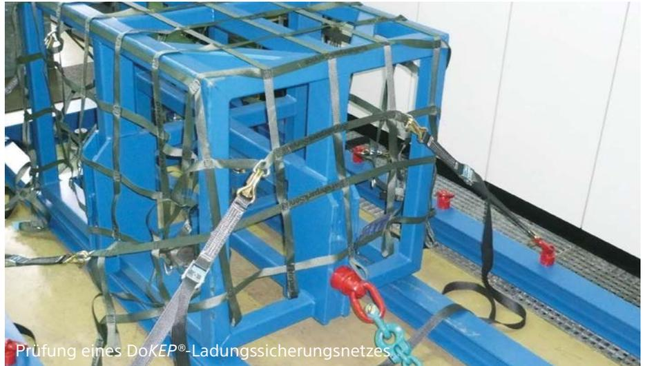
Prüfung eines DoKEP®-Ladungssicherungsnetzes
